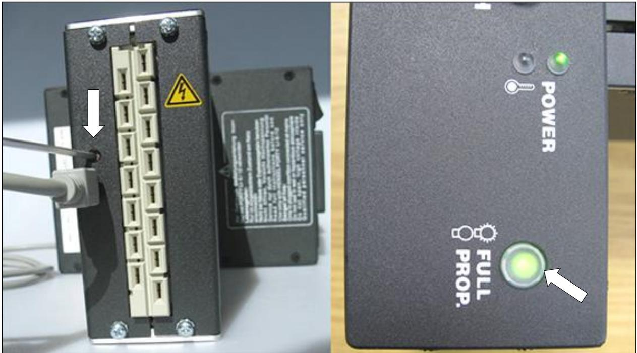
1) Verbinden Sie das Gerät vor dem Einschalten über die USB-Buchse mit dem Computer.
